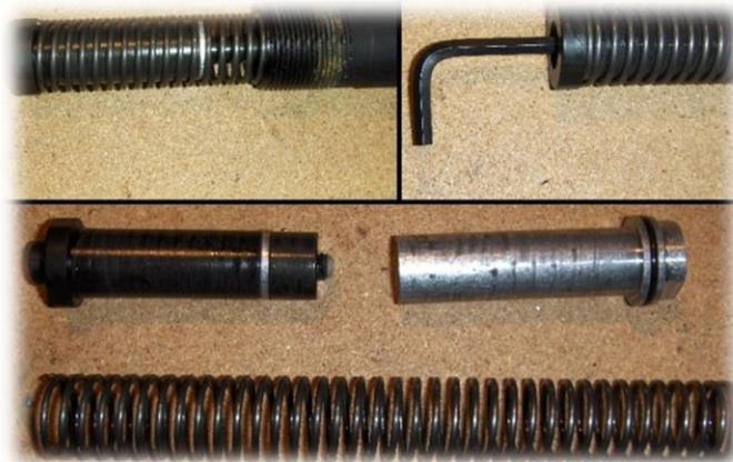
Die Stange wird wieder zusammenschraubt und nicht mehr weiter benötigt. Die Feder wird dann auf den leicht eingefetteten Tippys Hammer gesteckt.
