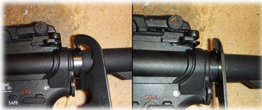
Das Abschrauben der Stock Tube muss vorsichtig erfolgen, damit die Halteplatte an welcher der Trageriemen eingehakt wird, nicht die darunterliegende Feder beschädigt. Die Feder sichert den Zerlegestift vom Lower Receiver.
