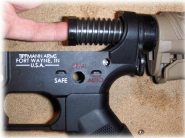
Nachdem die Federstange aus der Stock Tube gezogen wurde, wird jetzt mit Hilfe des Inbusschlüssels die Schraube am Ende der Federstange/Buffer gelöst und die Feder von der Stange gezogen.
