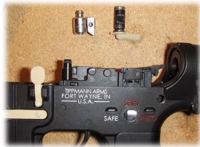
Die Federstange wird einfach mit dem kleinen Finger aus dem Rohr gezogen.
